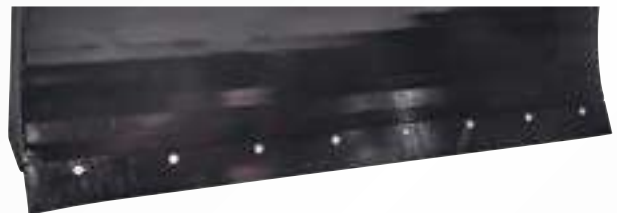
Geschraubte, hochverschleißfeste Schürfleiste (120 x 20 mm 500 HB)
