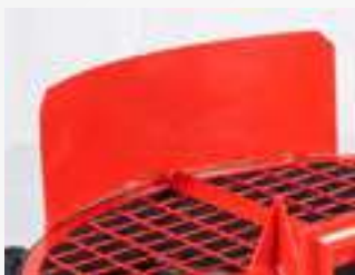
Vorderes Spritzblech zum Schutz des Traktors
