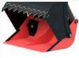
Geschlossener Schaufelboden mit innenliegender Aussteifung
