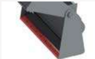
Geschraubte Schürfleiste 150 x 20 mm (500 HB) im Schaufelrücken
