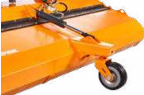
Hydraulische Schmutzsammelwanne mit 3. Stützrad
