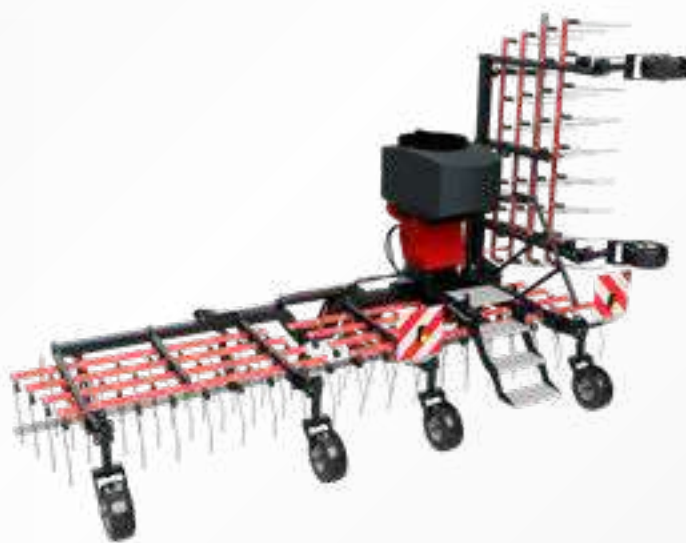
Exaktstriegel Perfekt ES 800 mit Aufbau-Podest, SAPHIR DrillStar und Beleuchtung
