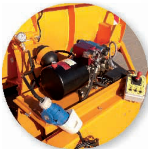
Eigene Hydraulikpumpe bei der PSS H Ausführung.
